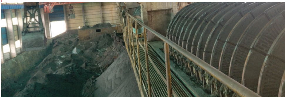
Керамический фильтр Flowrox великолепно справляется с фильтрацией хвостов медных руд.
