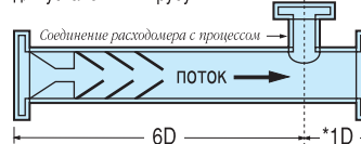
Формирователь потока (VMR) с участком трубопровода в месте установки расходомера
