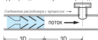
Формирователь потока (VMR) с участком трубопровода в месте установки расходомера
